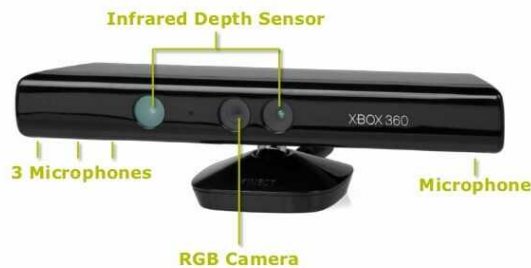
Gambar 13.1. Microsoft Kinect dan bagian-bagiannya.
